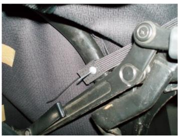
Etape 6 : Accrocher définitivement le câble : Reperer l'ancien point de serrage sur le câble, le tendre jusqu'à ce point et serrer à son niveau...
