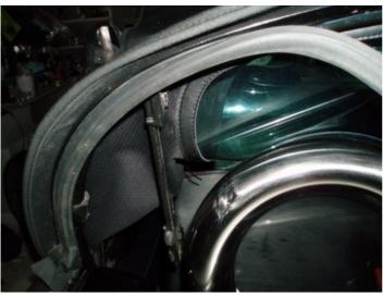
Etape 12 : On colle les battants en tissu de la capote sur la traverse 2 et sur la traverse 3 : dans les deux cas, on rabat le battant arrière vers l'avant puis celui de devant vers l'arrière...
