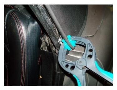
Piège de cette phase : La capote présente normalement dans son angle deux plis pour l'attacher : choisir le plus superficielle pour accrocher la capote : le plus profond servira plus tard pour accrocher la traverse 4.
