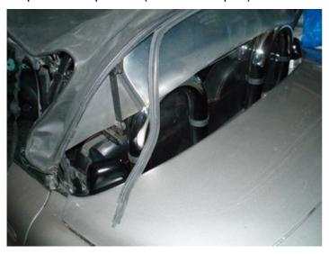
Etape 10 : Sous le grand joint, apparait la lame de maintien postérieure de la capote : On enlève les 11 vis cruciformes qui la maintiennent...
