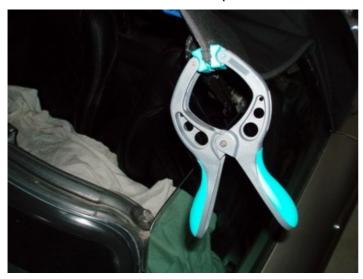
Etape 4 : Mettre de la colle sur la toile de la capote et sur la bande en caoutchouc (apès avoir repérer son sens) puis coller alors la bande en caoutchouc en faisant coincider les repérages blancs et les trous de la bande en caoutchouc puis remettre la barre métallique de maintien avec les 11 vis...
