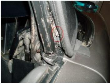
Piège : Aucun mais faut être patient... Moi, je préfère remplacer le rivet d'origine de 3 par un écrou "inox marin" de diamètre 4 et longeur 20. Pourquoi ? : car sur ma capote d'origine, les rivets avaient finis par s'arracher probablement car trop petits...
