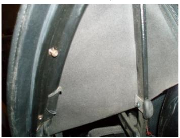
On dépose la lame : on découvre de nombreux points d'oxydation : il va falloir la traiter...
