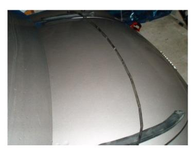
Etape 6 : On incise l'angle de la capote au cutter pour ouvrir cet angle et on retire petit à petit la bande en caoutchouc d'étanchéïté qui se trouve dessous : ne pas la jetter car elle va resservir...
