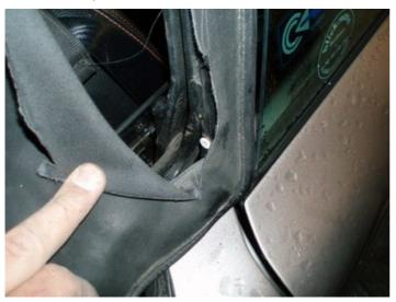
Attention on récupère les deux éléments de la photo suivante... Ils servent, de part leur forme en goutièrre, à maintenir plaquer la capote dans le fond de la rainure du montant C...
