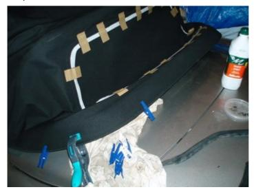
Etape 11 : On remet alors la lame métallique arrière et ses 11 vis... et on raccroche le grand joint arrière sur son rail...
