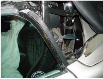
On enduit copieusement le montant C (bord interne-bord externe-arête-bande d'étanchéïté) avec la colle et on accroche soigneusement la capote dans l'angle du montant C de chaque côté : Attention, cette opération est cruciale.... l'angle de la capote doit être solidement fixée... On met des pinces auto serrantes... Je recommande d'attendre le temps de prise définitif de la colle avant de passer à la phase suivante...
