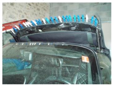
Etape 3 : Si le bord de la capote qui est replié cache les trous de la traverse 1 : les reperer au travers de la capote avec une aiguille fine (ou autre objet pointu : ici un foret) et noter leur position avec un fin stilo "blanco"...
