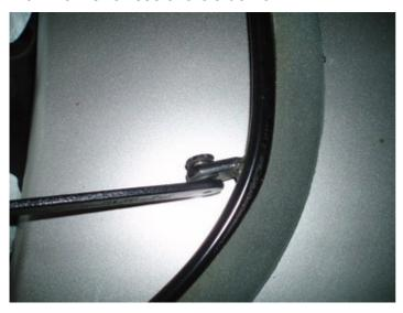
. De l'oxydation, s'est formée également sur le montant C : ponçage, Framéto puis peinture antirouille feront l'affaire...
